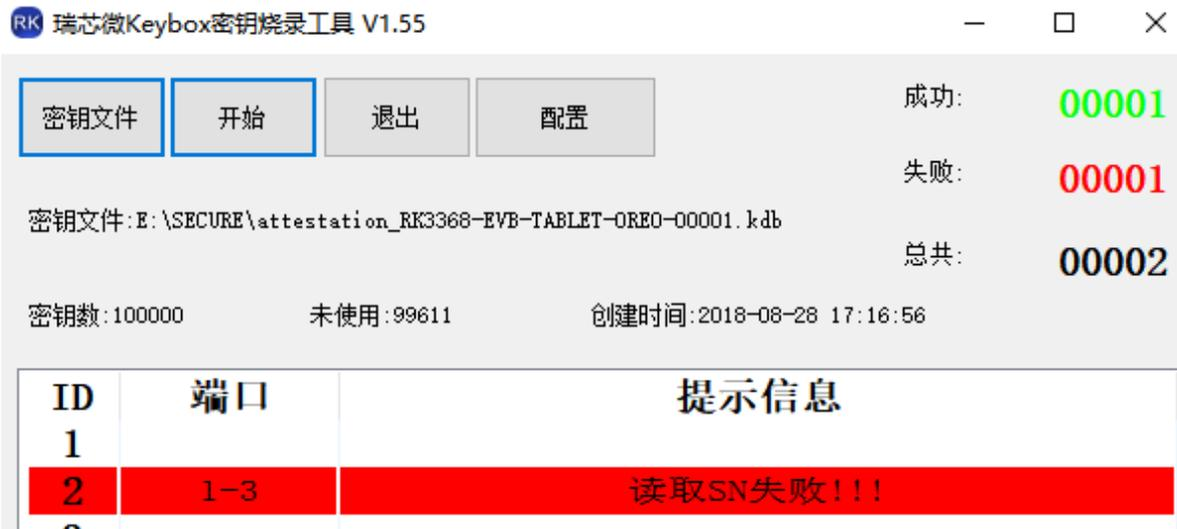
2. 设备烧完系列号后，必须重启正常开机后，再重新进入loader模式，然后使用KeyboxWriter 获取RKP CSR.
