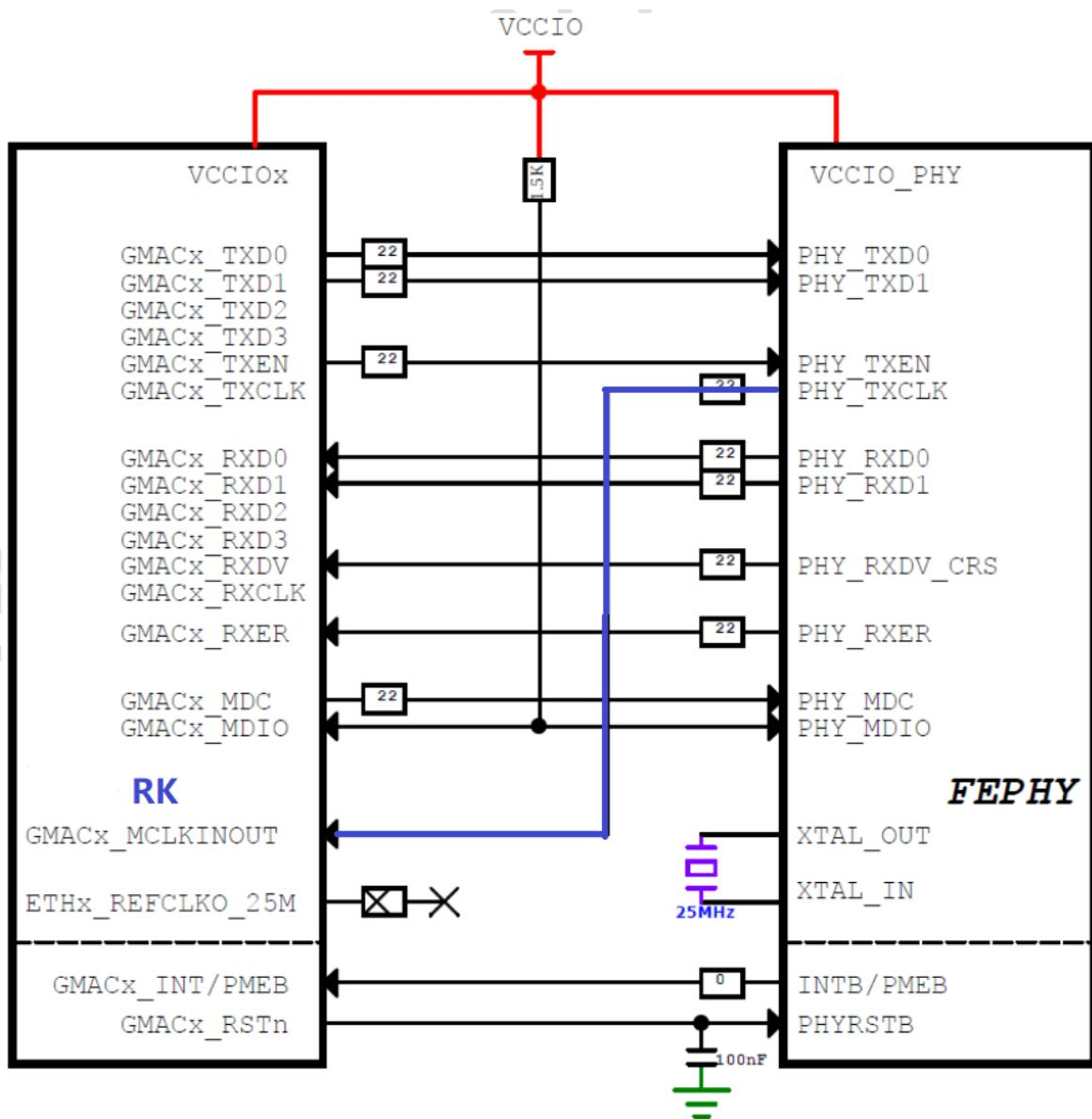
同样，RMII 模式下，晶振也可以由主控输出 25M 替代。
