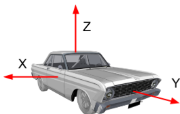
图 2. Sensor API 使用的坐标系（相对于汽车设备）。
