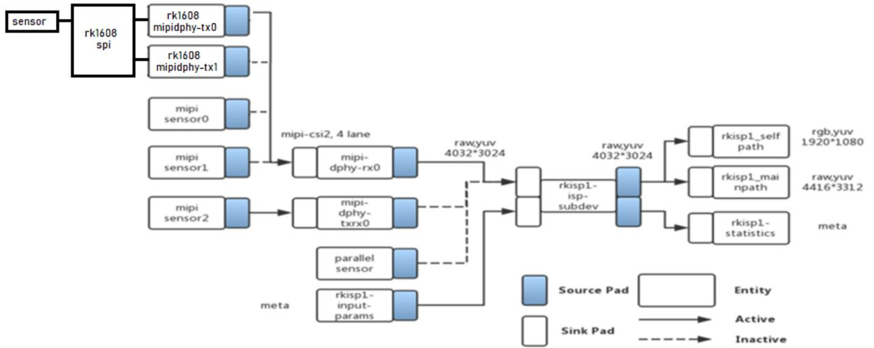
sensor i2c 可以被 AP 控制，也可以被 1608 直接控制。
