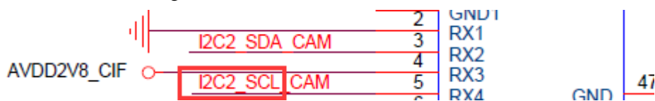
图 28 原理图 I2C 编号示例
