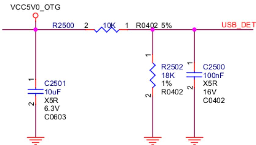
图 2-7 USB 2.0 OTG VBUS DET 分压电路
