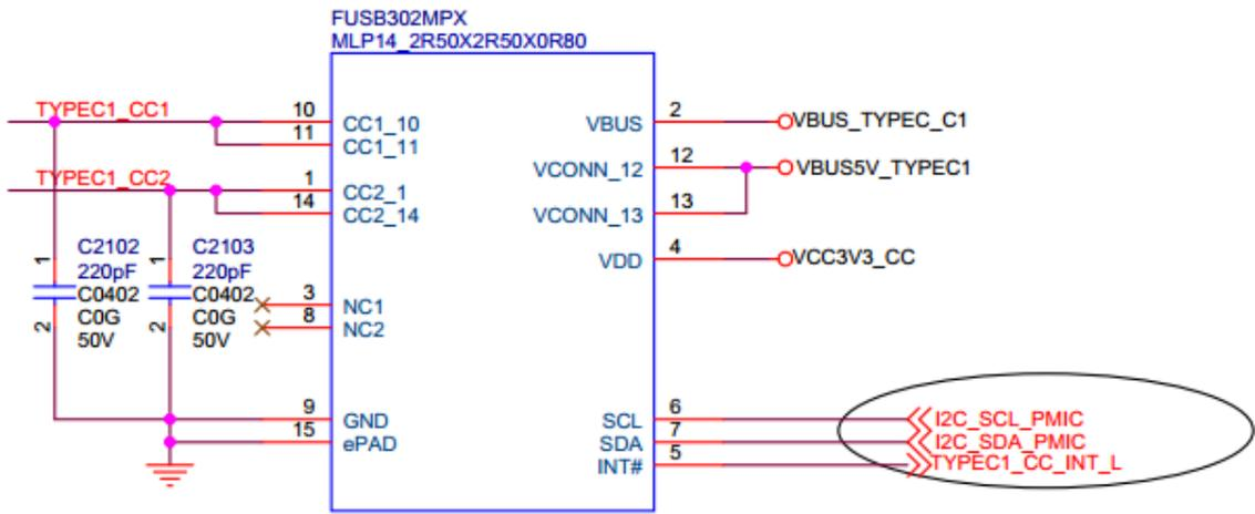
图 2-12 USB 3.0 Type-C FUSB302 电路
