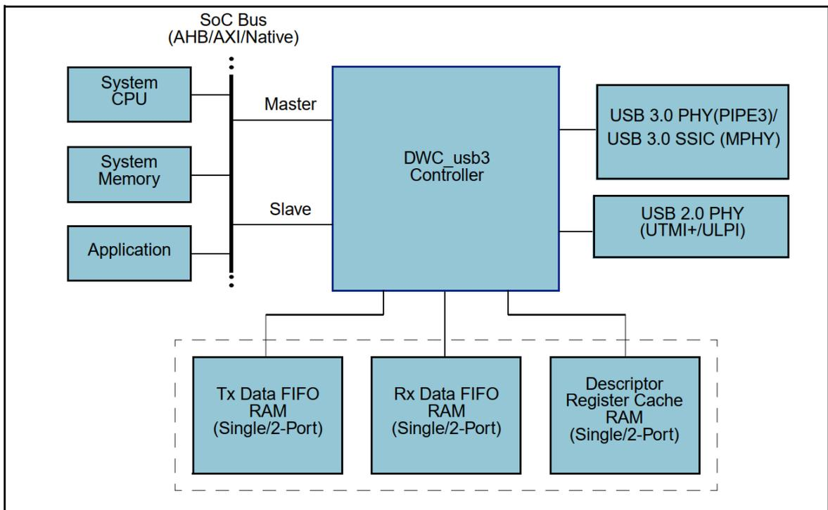
图 5-5 DWC3 控制器系统级框图
