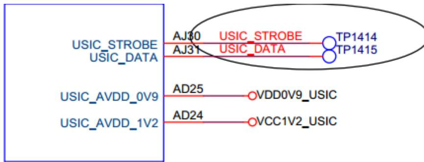
图 2-4 USB 2.0 HSIC 硬件电路
