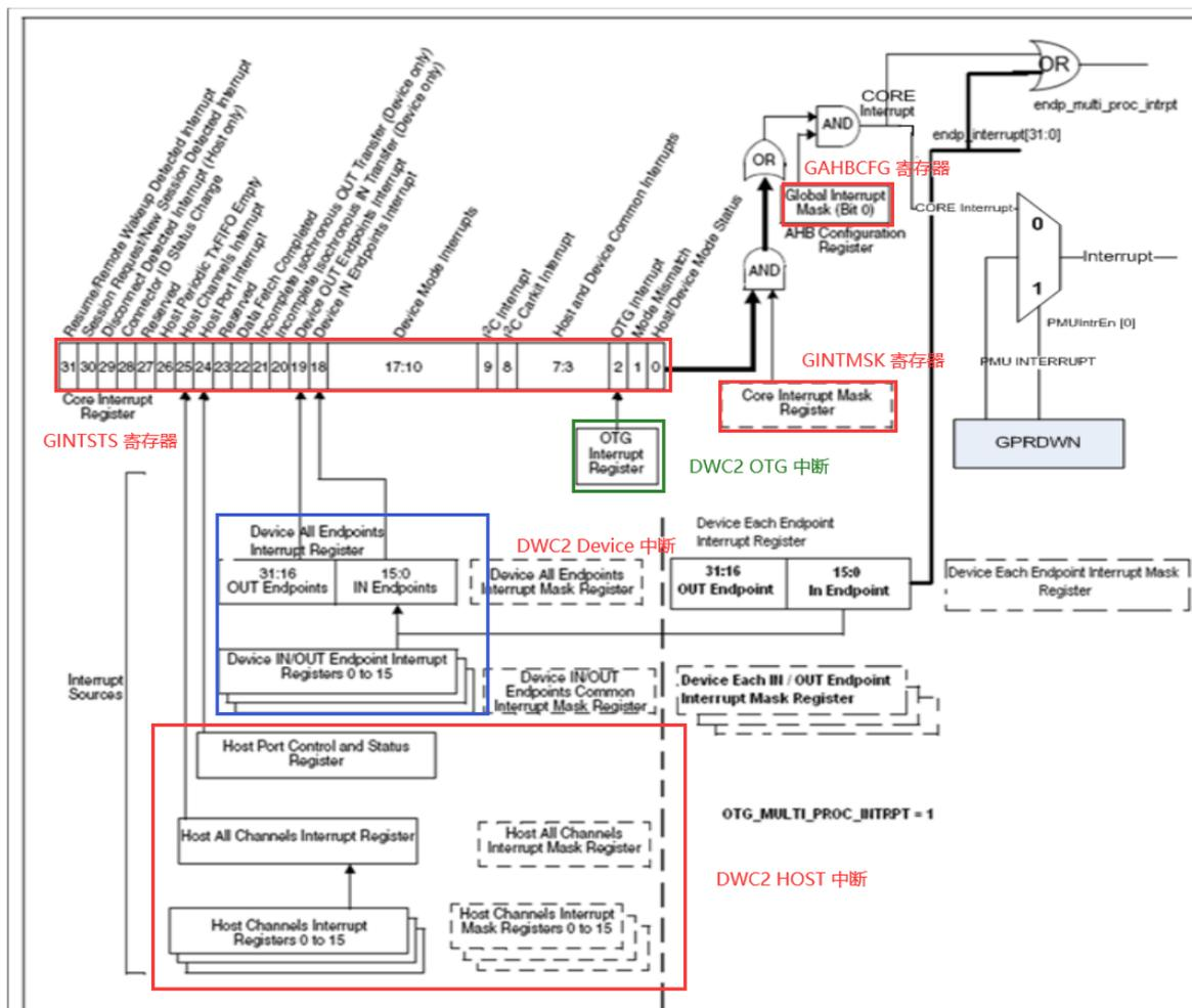
图 5-3 DWC2 控制器的中断层级
