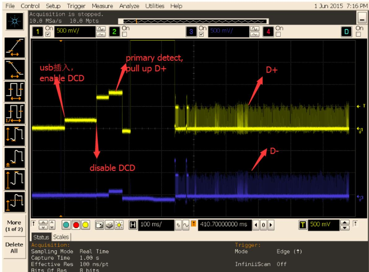
图 8-2 SDP 检测波形
