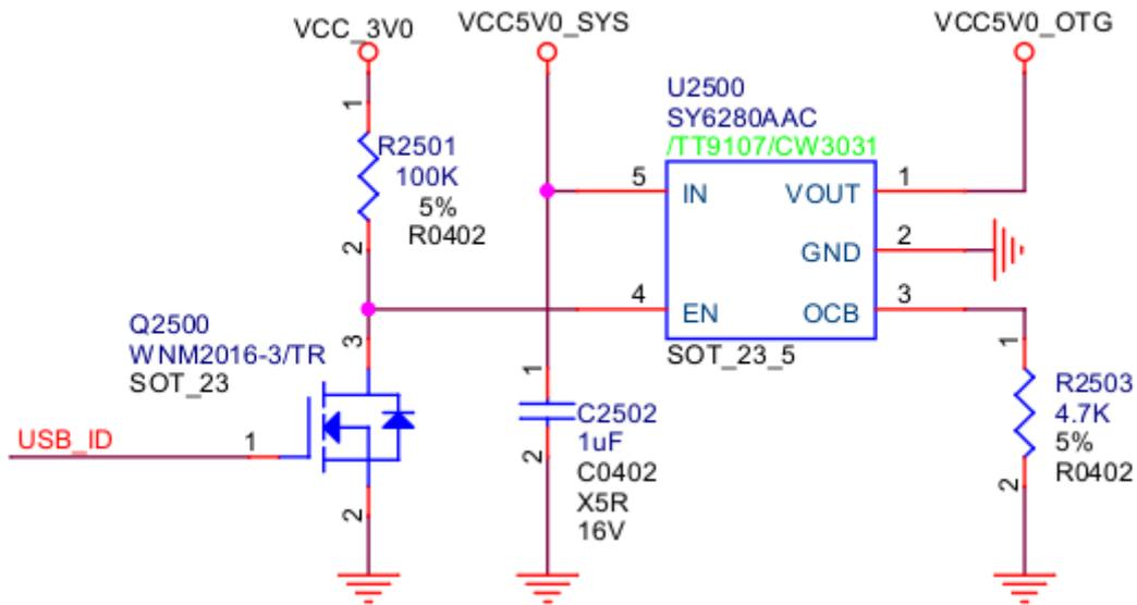
图 2-8 USB 2.0 OTG VBUS DRV 电路
