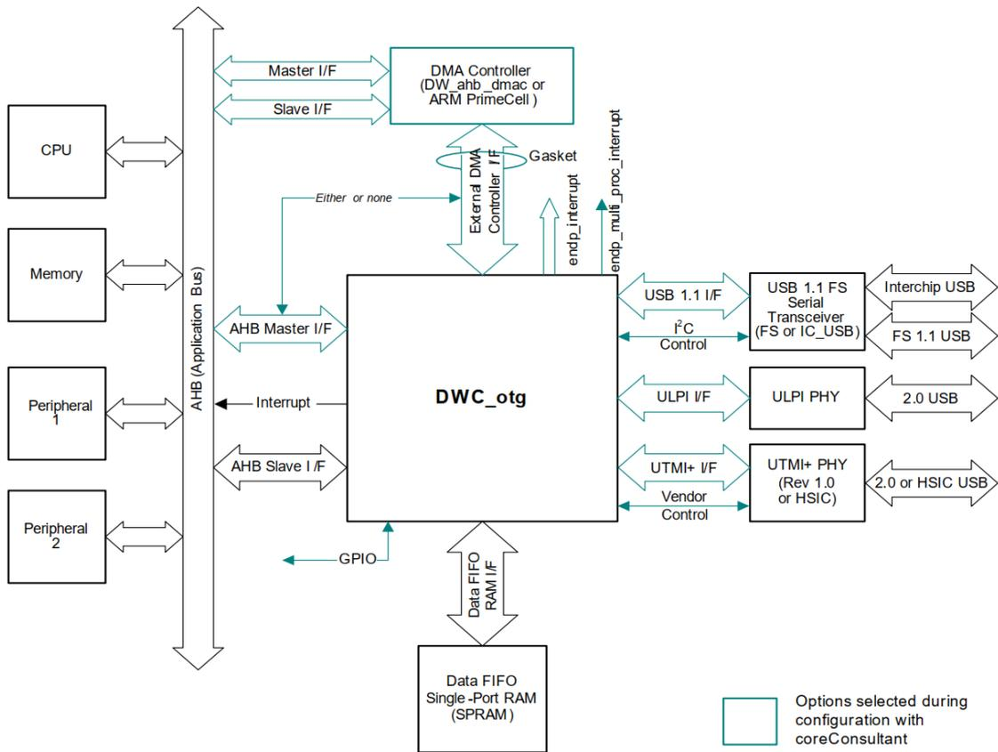
图 5-2 DWC2 控制器系统级框图
