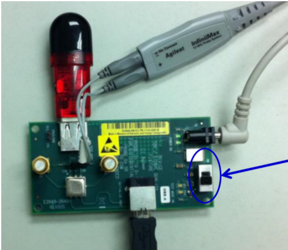
图 5 Agilent USB 2.0 SQ 测试夹具连接方法
